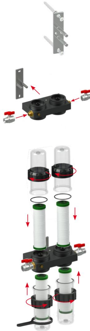
**1** Die Wandhalterung mit geeignetem Material (Dübel, Schrauben) an der Wand befestigen.
