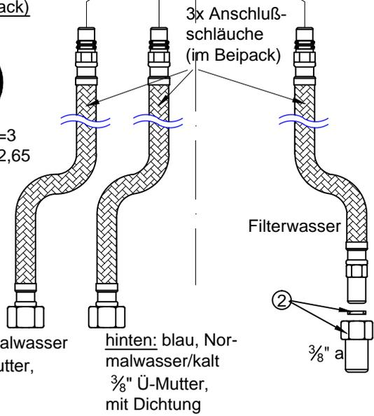
vorn: rot, Normalwasser/warm 3/8" Ü-Mutter, mit Dichtung
